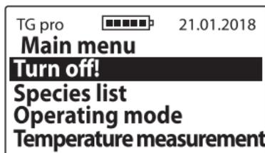
1) **Turn off (Desligar)** - A primeira opção exibida é utilizada para desligar o produto, ao selecionar essa opção o aparelho irá se desligar; outras formas de desligar o aparelho são: pressionar o botão
