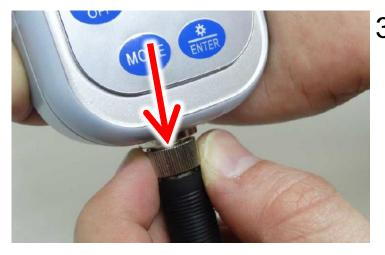
3) Para desrosquear a sonda, desrosqueie a anilha de metal, com cuidado, e remova a sonda, puxando através da proteção emborrachada do conector, NUNCA pelo cabo!
