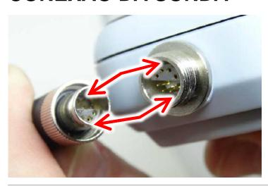
Alinhe a posição dos pinos e ranhuras do conector da sonda para encaixar corretamente na conexão do instrumento;
