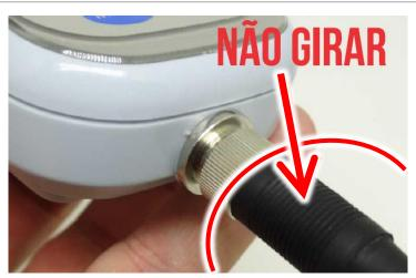
Rosqueie a anilha de metal para atachar os conectores, tendo cuidado para não girar o cabo ou a proteção emborrachada do conector;
